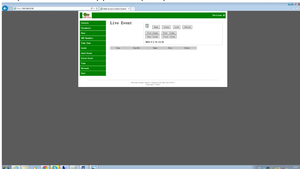
8. Проверить работоспособность контроллера можно нажатием на кнопку «Open». При этом сработает реле в контроллере, будет слышен характерный щелчок.
